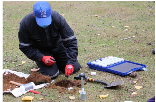
Figura 2. Toma de muestras inalteradas de suelos en superficie (0-20 cm). La cobertura, corresponde a una pradera naturalizada pastoreada por ovinos, en la localidad de Cochrane (Sitio B).
